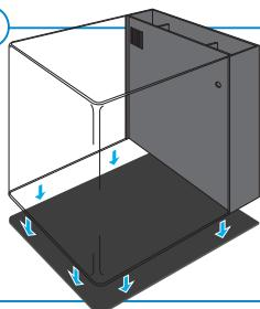
Plaats de aquarumbak (1) op de bodembeschermemat (16). Plaats het aquarium op een vlak, glad, horizontaal en voldoende belastbaar oppervlak. Plaats het aquarium niet op of boven elektrische apparaten of op meubels met watergevoelige oppervlakken.
