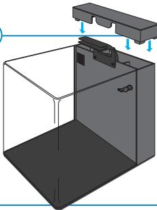
Plaats de kap (17) op de filterbak. Pas de stand van de armatuur aan zodat deze goed past in de daarvoor bestemde uitsparingen en draai de schroeven vast.
