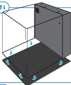
Stellen Sie den Tank (1) auf die Schutzunterlage (16). Platzieren Sie das Aquarium auf einer glatten, waagerechten Fläche mit ausreichender Tragfähigkeit. Stellen Sie das Aquarium nicht auf Elektrogeräte oder auf Möbeln auf, die durch Wasser angegriffen werden können.
