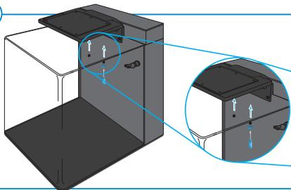
Zet de verlichting vast met de bevestigings-schroeven (13) gebruik hiervoor de meegeleverde schroevendraaier (14).
