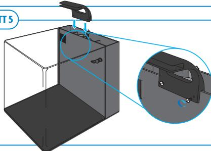
Setzen Sie die Halterung der Beleuchtung (4) auf die Kante des Sumpfes und ziehen Sie die Befestigungsschrauben für die Halterung (12) leicht an, so dass sie auch bei montiertem Sumpfdeckel bewegen werden kann.
