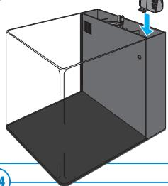
Placez la pompe (3) (BM ReefPower 600) dans la section droite du filtre.
