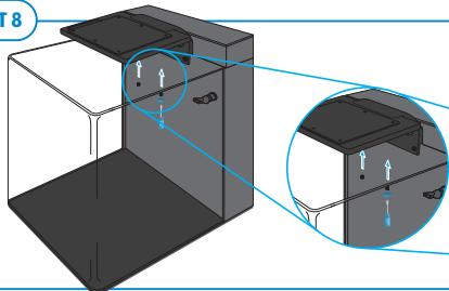
Sichern Sie die Beleuchtung unter Verwendung des Schraubenziehers (14) mit den Befestigungsschrauben (13).
