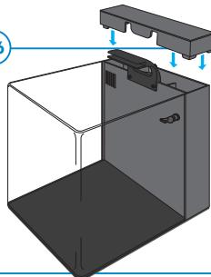
Placer le couvercle (17) sur le filtre. Réglez la position de l'éclairage afin qu'il s'insère dans les ouvertures du couvercle, puis serrez les vis.
