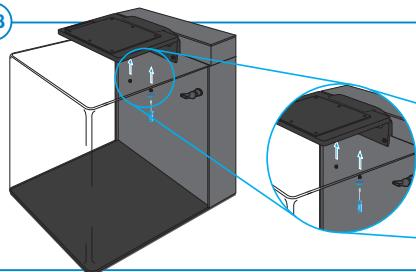
Fixer l'éclairage avec les vis de fixation (13) à l'aide du tournevis (14).
