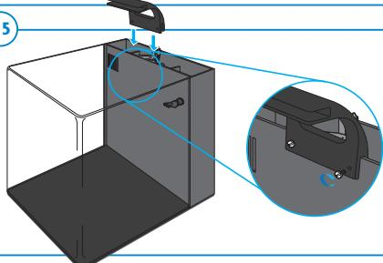
Fixez le support d'éclairage (4) sur la vitre intérieure du filtre et serrez à la main les vis de fixation (12) de manière à pouvoir ajuster son positionnement, si besoin.
