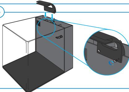
Plaats de verlichtingsarmatuur (4) over de rand van de filterbak en draai deze handvast met de bevestigingsschroeven voor de armatuur (12) zodat deze nog verschoven kan worden wanneer de filterbakkap geplaatst wordt.
